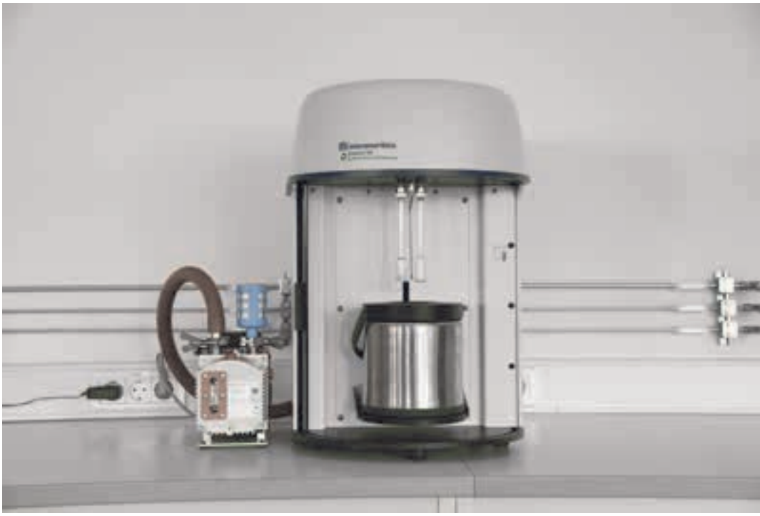
Abbildung 1: Drehschieberpumpe Duo 1.6 von Pfeiffer Vacuum im Einsatz an einem Oberflächenanalysator der Micromeritics GmbH.
